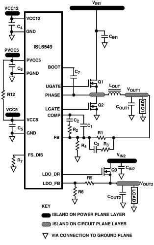
FIGURE 13. PRINTED CIRCUIT BOARD POWER PLANES AND ISLANDS
