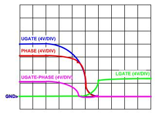
FIGURE 12. GATE DRIVER WAVEFORMS
