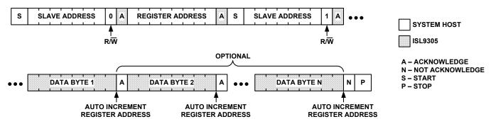
FIGURE 7. I<sup>2</sup>C READ SPECIFYING REGISTER ADDRESS
