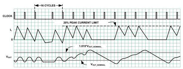
FIGURE 2. SKIP MODE OPERATION WAVEFORMS
