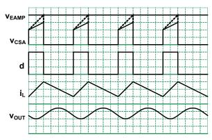
FIGURE 3. PWM OPERATION WAVEFORMS
